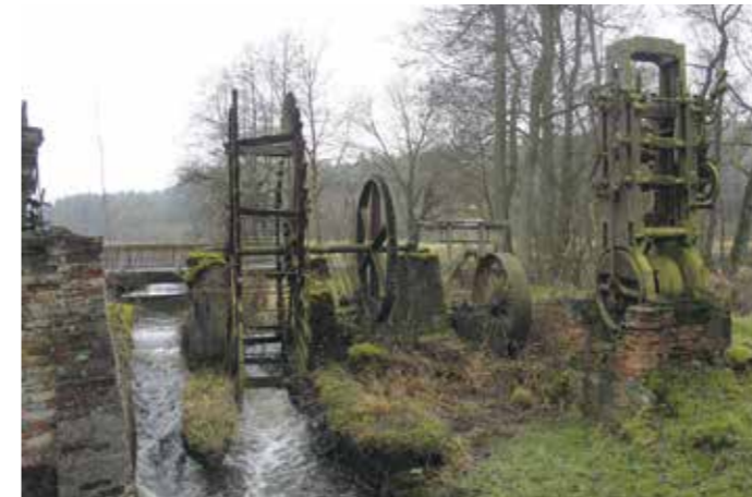
Neben der Wassermühle Schönthal blieben Reste des Wasserrads und des einst angeschlossenen Sägewerks erhalten. Foto: Schabe / Deutsche Stiftung Denkmalschutz
