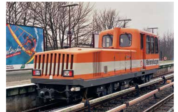
1989 lieferte die Schalker Eisenhütte einen motorisierten Gleismesswagen an die Hamburger Hochbahn AG. Foto: Sven Bardua, 1994
