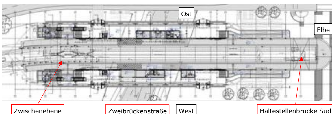
Abbildung 70: Grundriss U-Bahnstation Elbrücken
